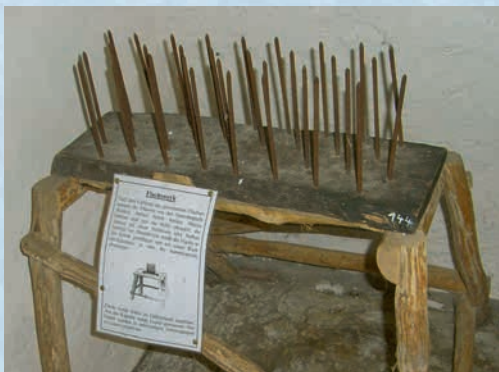
Mit dieser Riffel wurden die Samenkapseln vom Flachs getrennt. Aus dem Samen gewann man das kostbare Öl.
